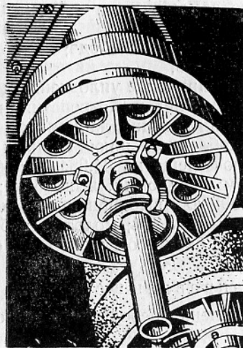
Рис. 4. Установка приспособления УК-1А для спрессовки направляющего колеса (опорного катка)
